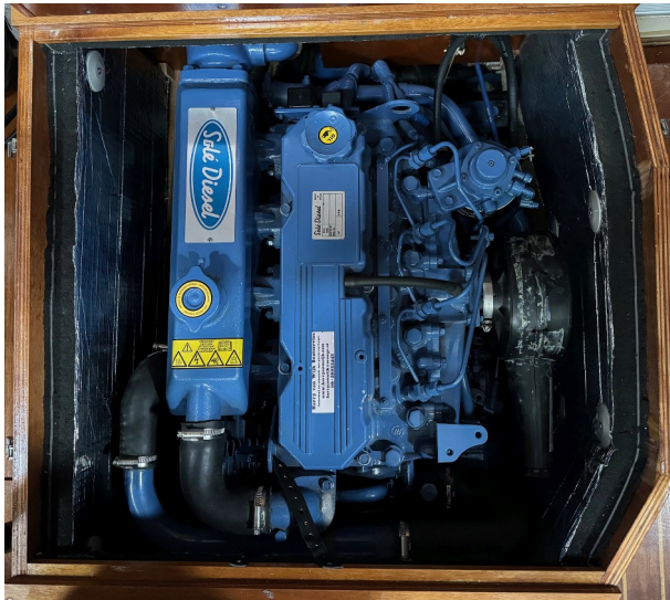
Motor, ingebouwd met geluidsisolatie
