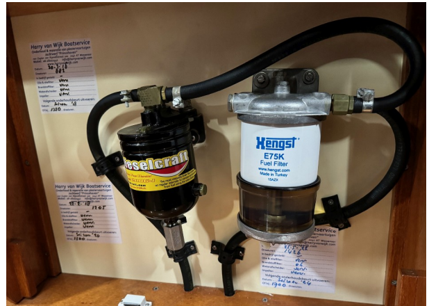
Brandstof filters, ruim toegankelijk
